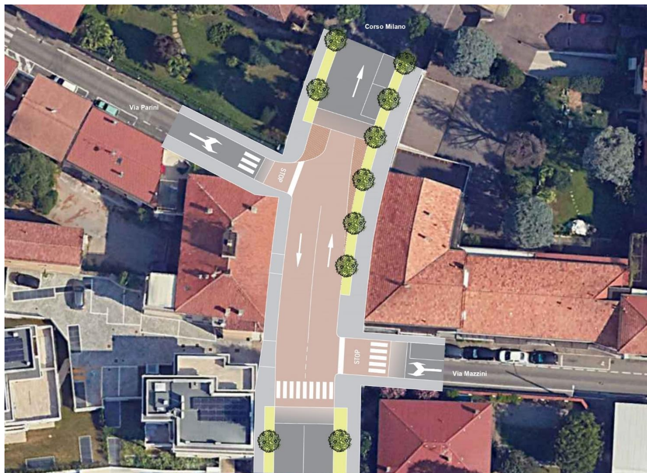
Figura 9: Piattaforma rialzata di corso Milano tra Via Mazzini e via Parini
